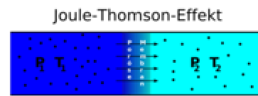
schematische Darstellung des Joule-Thomson-Effekts
